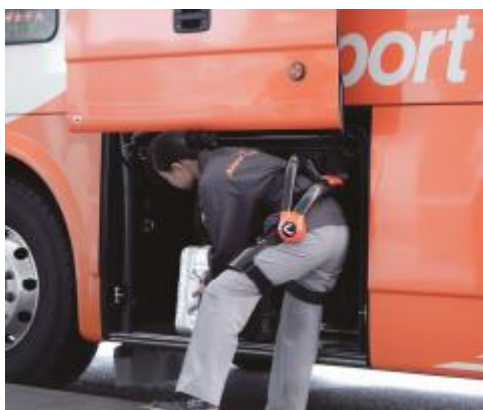
写真6-1-2 パワーアシストスーツを着用しての羽田空港でのバスからの荷卸し作業
