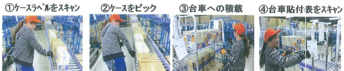
写真 3-2-11 シュート下での作業手順
