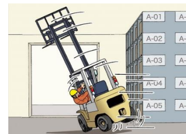
(2) フォークを高くした不安定な状態で急旋回による転倒
