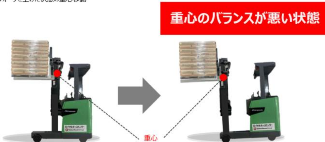
リーチアウト+フォークを上げた状態の重心移動
