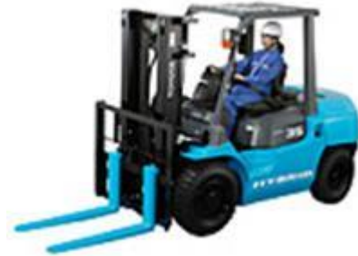
(写真6 豊田自動織機 ニッケル水素電池搭載)
