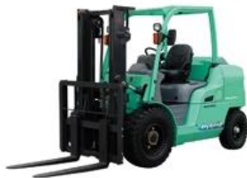
(写真5 三菱重工業 リチウムイオン電池搭載)
